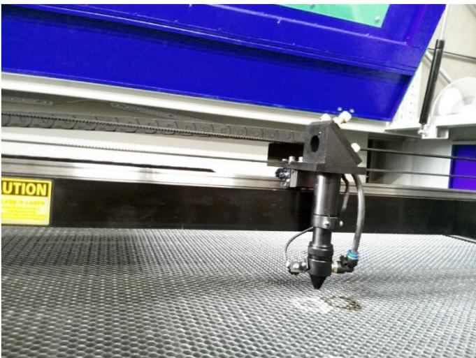
Головка лазерной резки.
