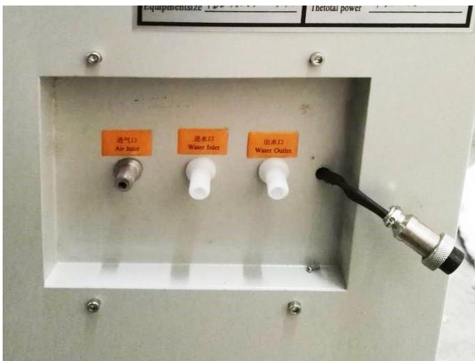
Зона подключения воды, воздуха и заземления.
