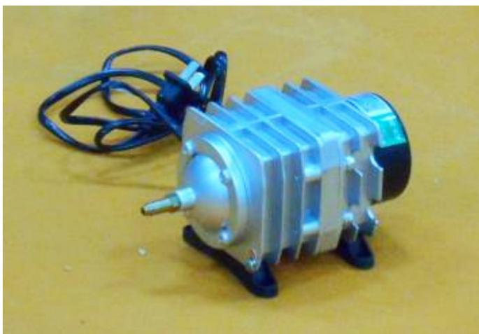
Портативный компрессор для обеспечения выдува дыма из зоны обработки.
