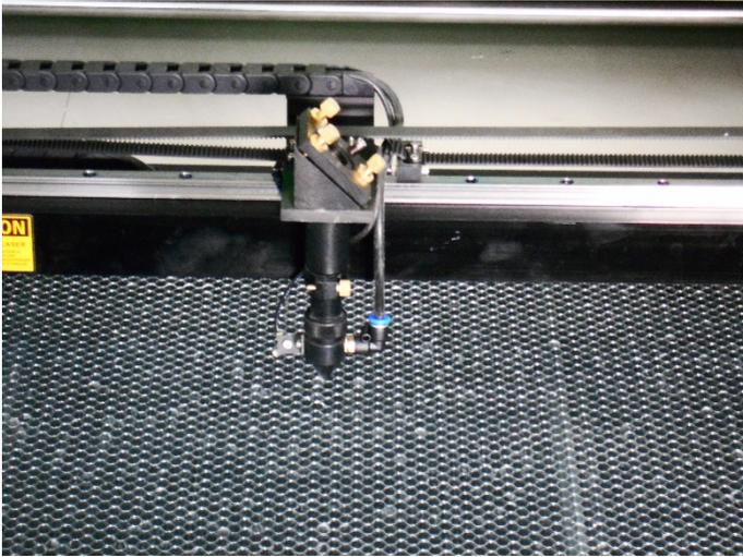
Ячеистый или ламельный стол с размером поля обработки 1200x900 мм.
