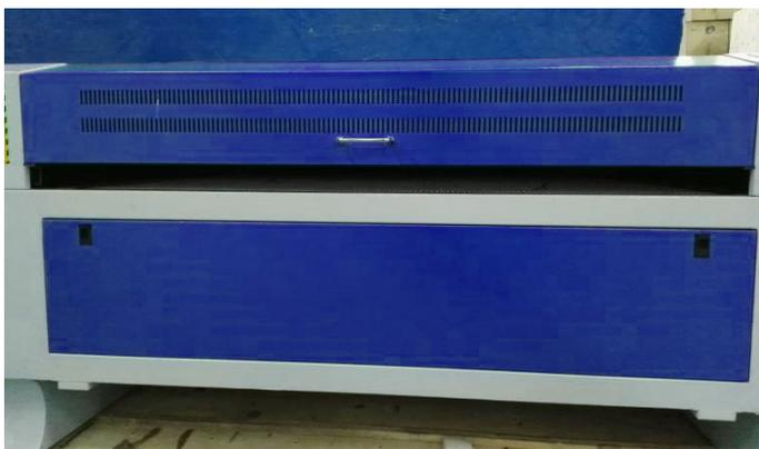
Наличие технологической щели на фронтальной и задней части станка даёт возможность сквозного прохода заготовок и работы с заготовками без ограничения длины в том числе с рулонными материалами.
