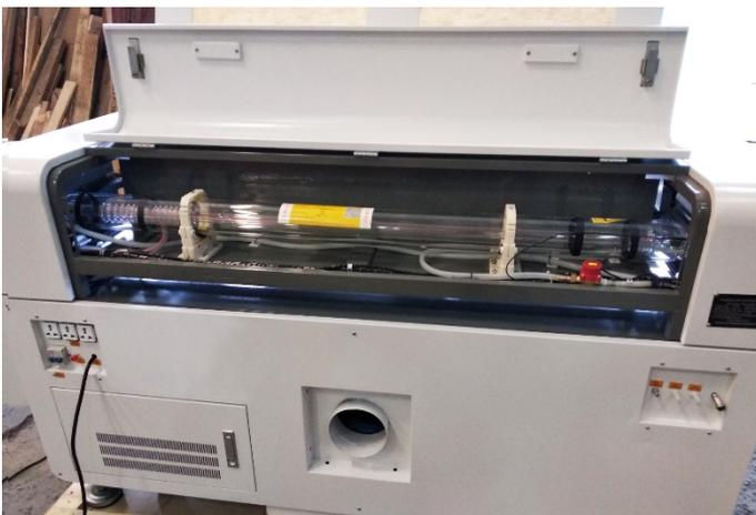
Колба CO2 лазера мощностью 100 Вт.
