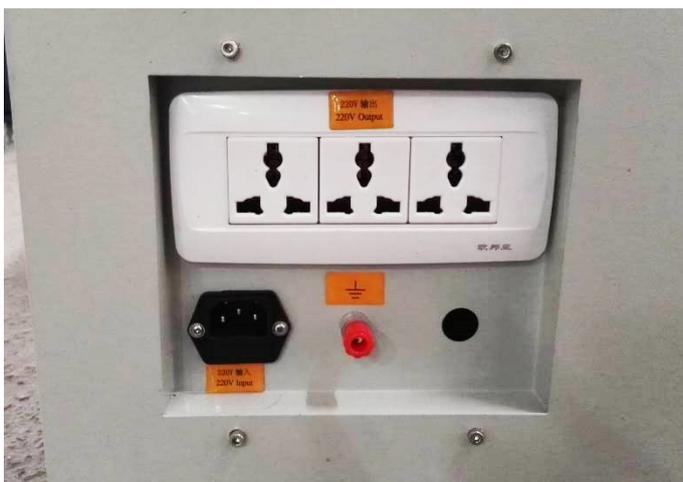
Централизованная зона подключения электрической части необходимых для работы станка.
